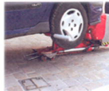
2° FASE Bloccaggio, in massima sicurezza, dei bracci attorno alla ruota
